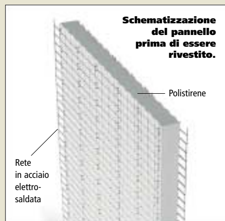
Schematizzazione della "parete tipo" realizzata con i pannelli.
