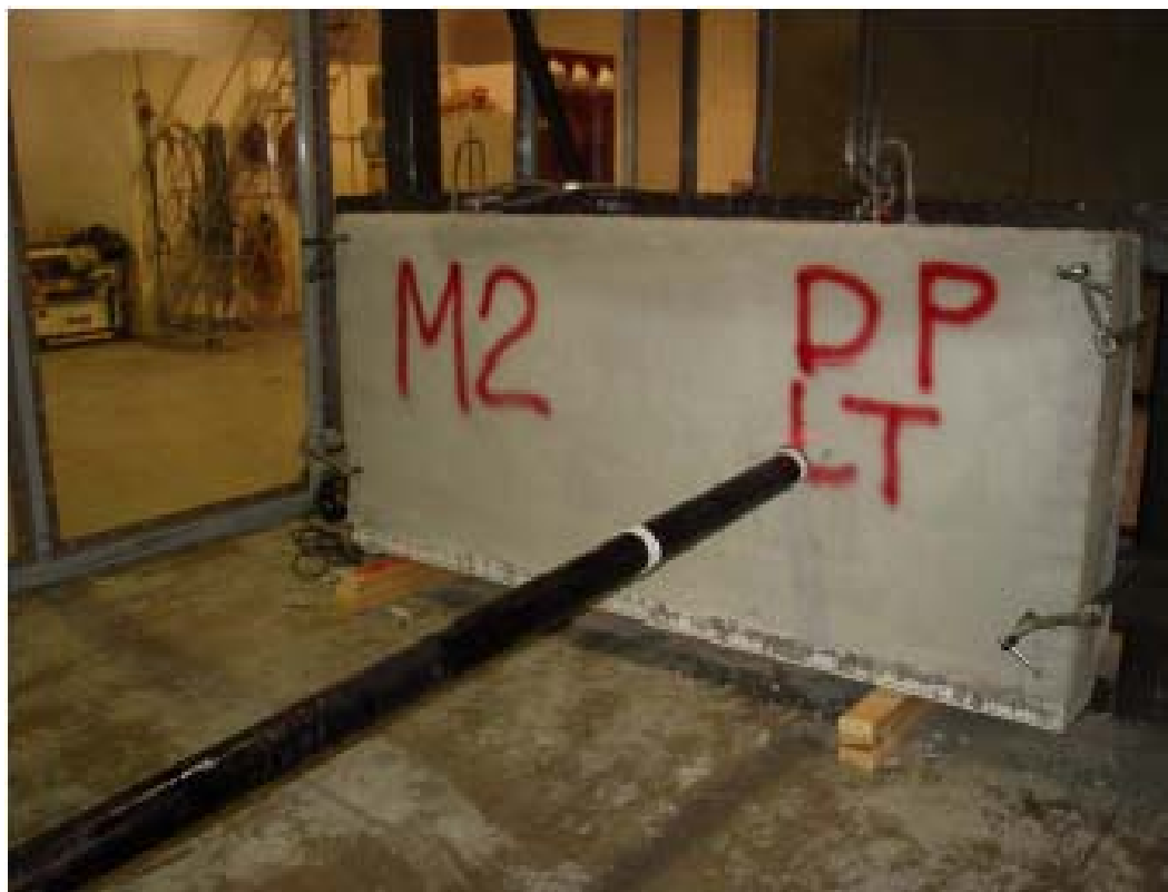
Impatto I con il missile della prova di controllo nucleare IV serie protocollo 5a
