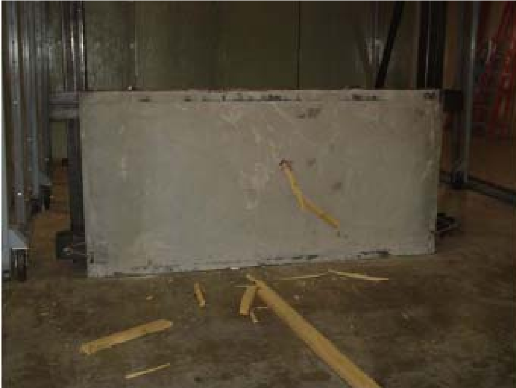
Impatto sul pannello del missile del tornato protocollo I - V serie
