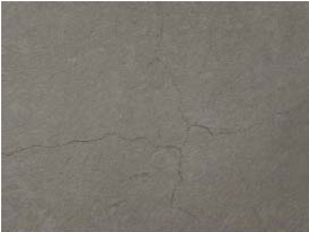
Crepe radiali sul lato posteriore del campione di impatto della III serie
