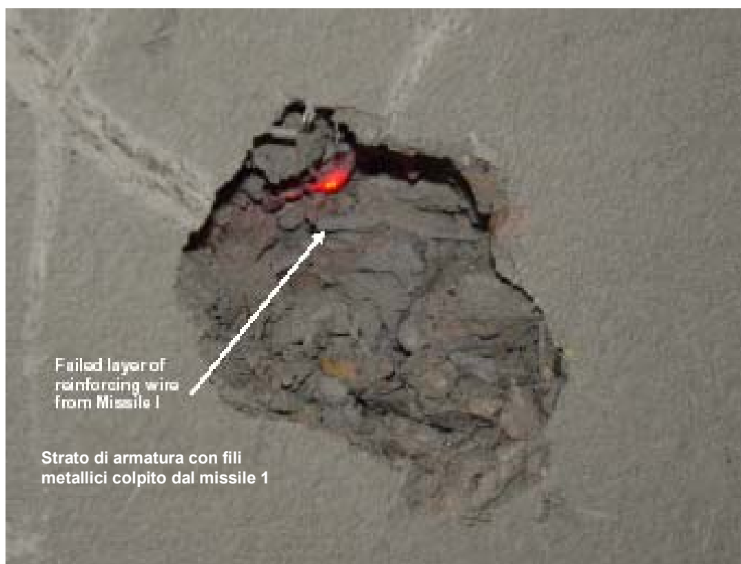
Penetrazione del missile 1 del tornado nel pannello della V serie
