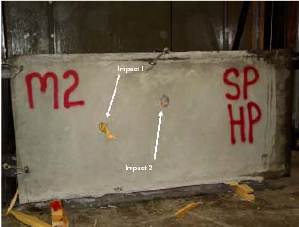
Impatto della II serie da parte del Missile per riparo antitornado II
