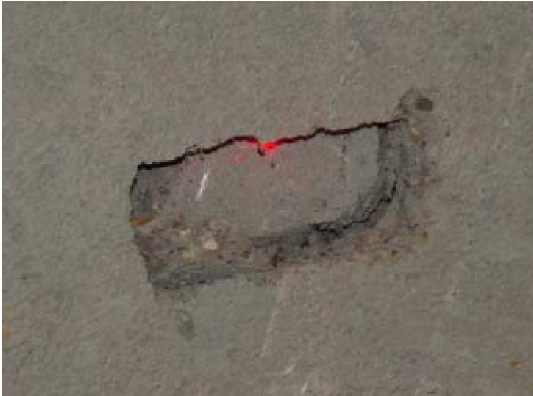
Pannello della V serie colpito dal II missile del test anti-tornado
