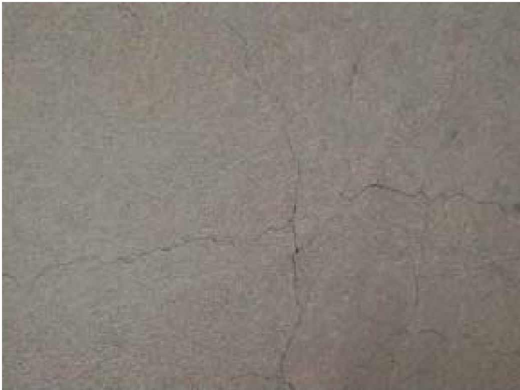
Crepe radiali sul lato posteriore del campione della IV serie
