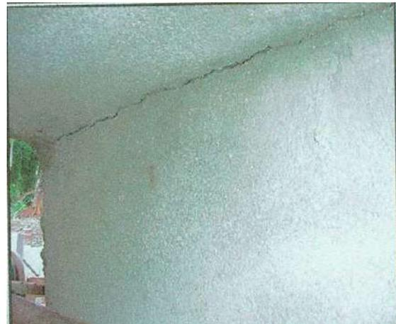
**Figura 3.13** – Difetto tipico del collegamento angolare con carico pari a 1591 kg (3500 libbre)
