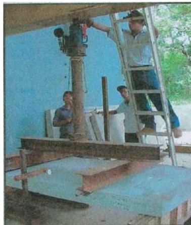
**Figura 3.10** – Installazione del sistema di carichi per la prova a flessione
