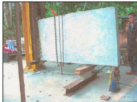
**Figura 3.1** Prova di resistenza al taglio sui pannelli
