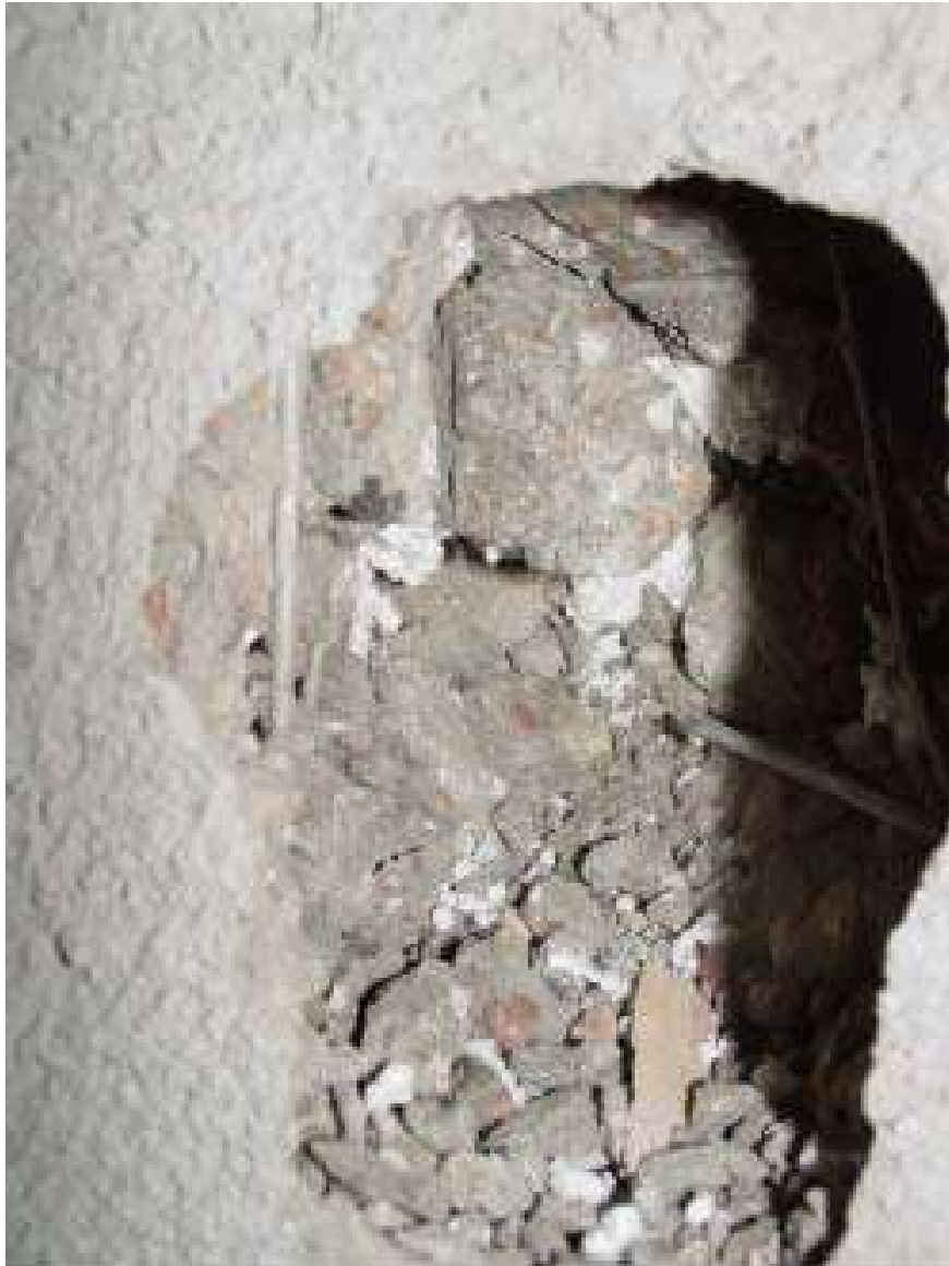
Foro creato dall'impatto con il missile per ripari antiuragano della II serie
