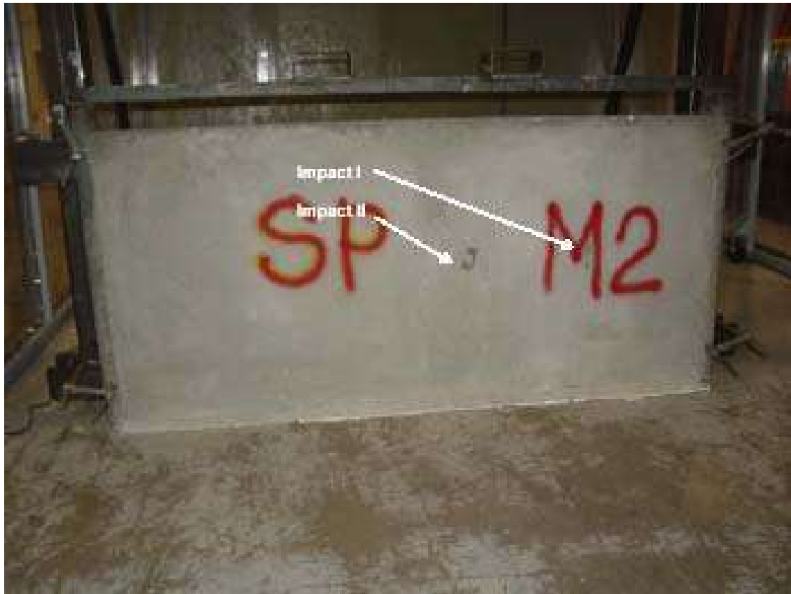
Campione della I serie colpito dal missile II del Protocollo antiuragano
