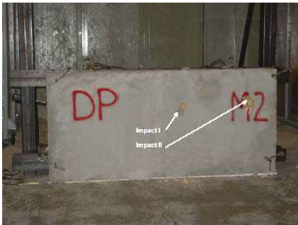
Pannello della III serie colpito dal missile II del tornado
