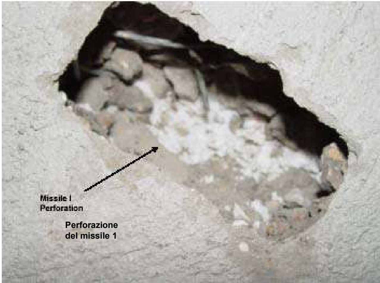
Lato dell'impatto del pannello della II serie dopo l'impatto I con il missile per ripari antiuragano
