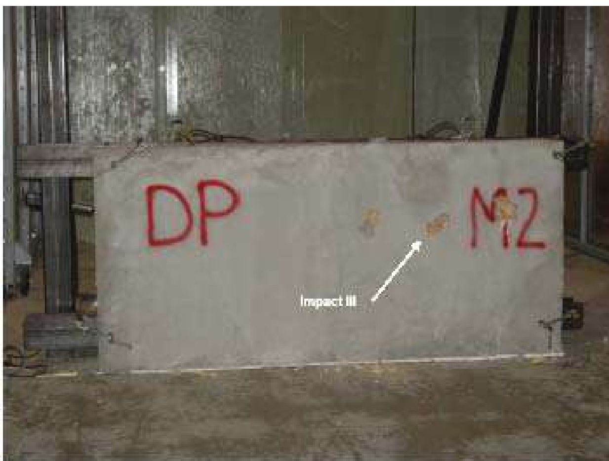
Pannello della III serie colpito dal missile III del tornado
