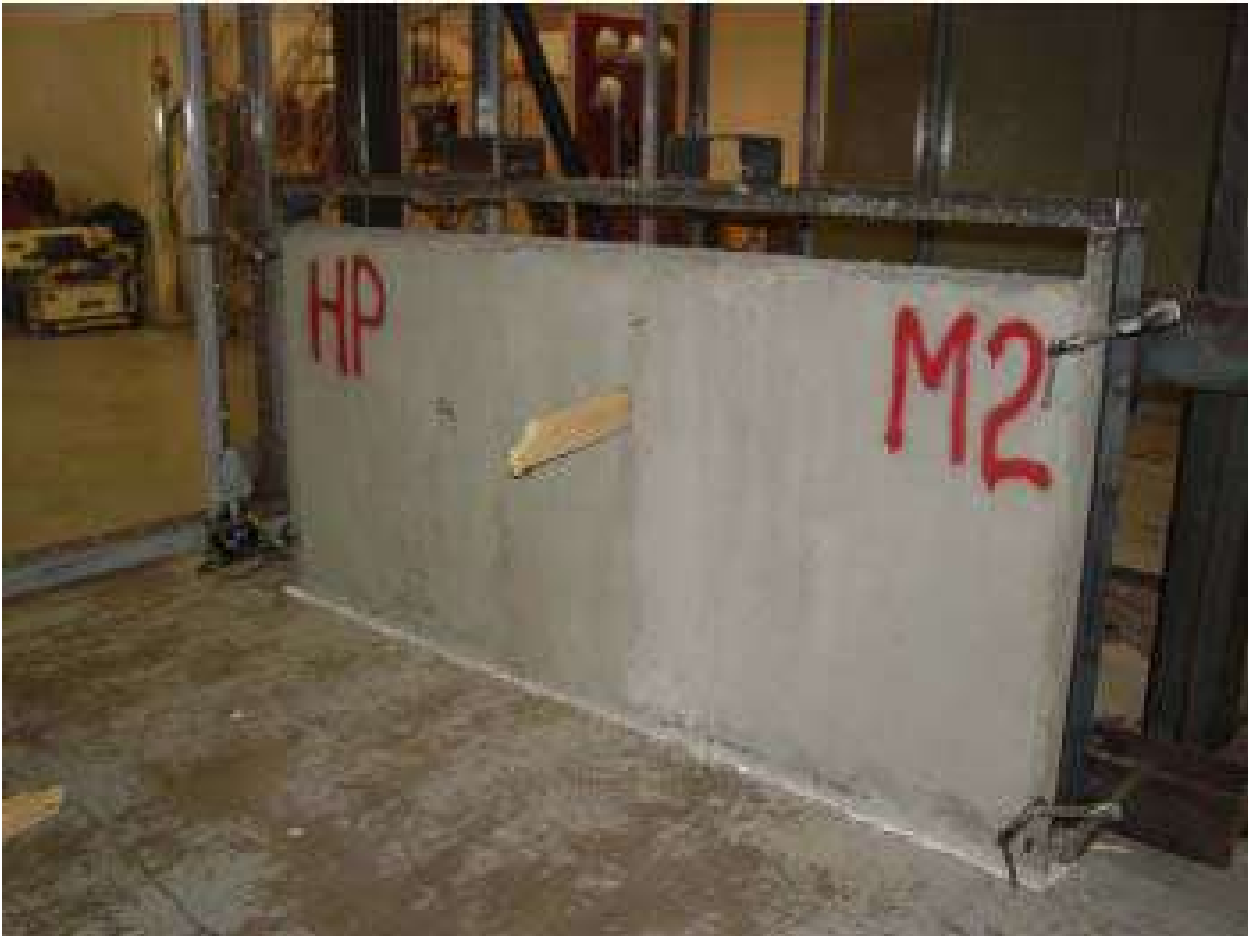
Pannello della II serie colpito dal missile II per ripari antiuragano
