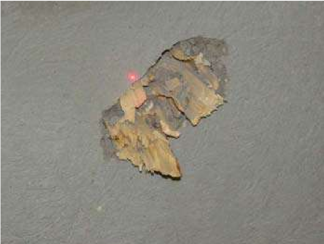
Pannello della III serie colpito dal missile I del tornado
