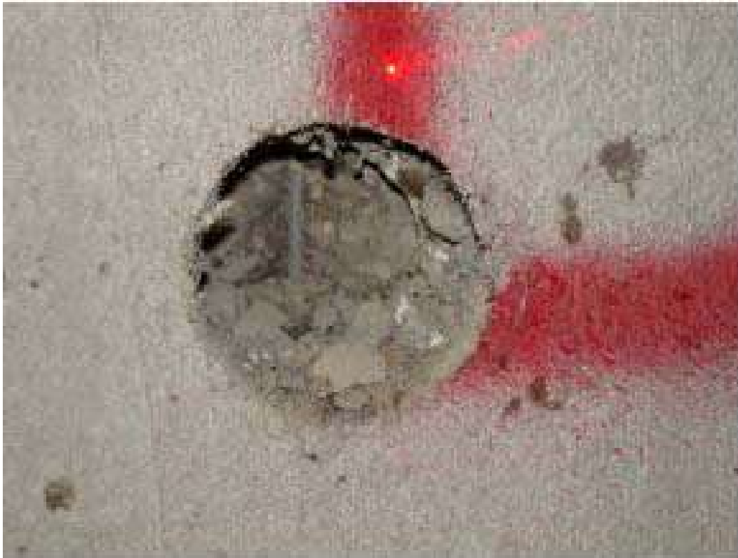
Danno dell'impatto con il missile I sulla IV serie protocollo 5a
