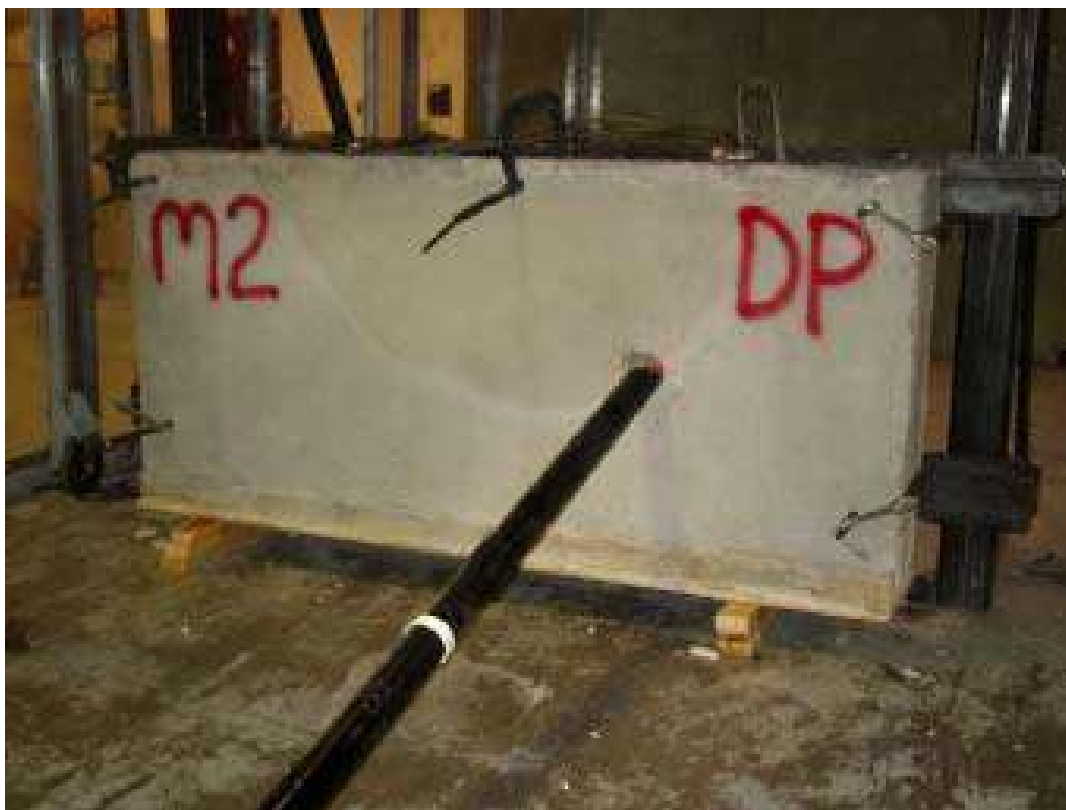
Pannello della III serie colpito dal missile della prova di controllo nucleare
