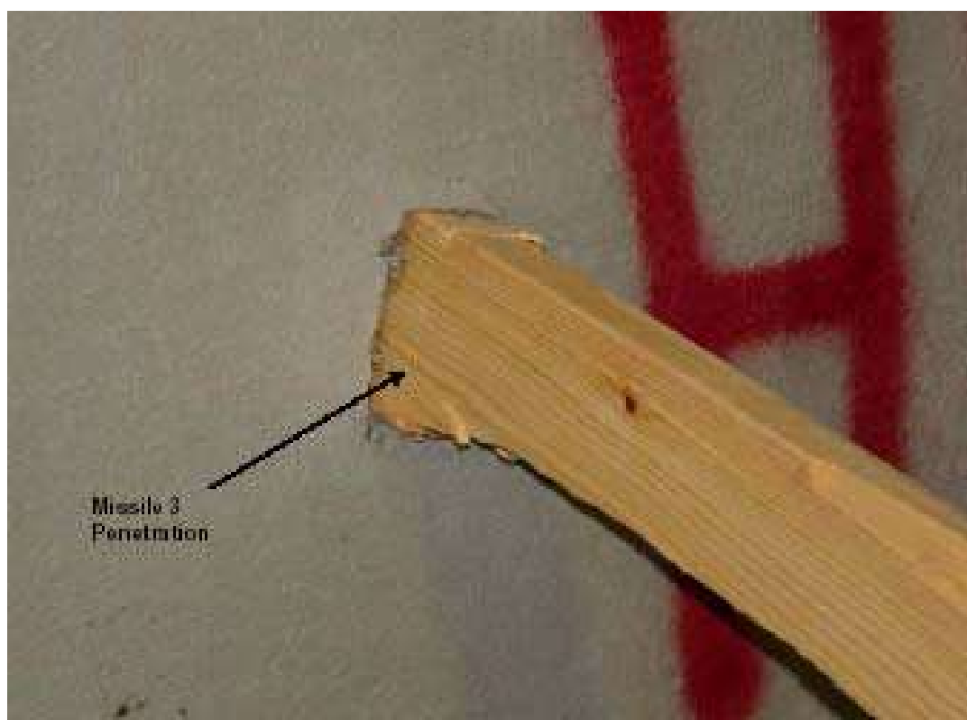
Lato dell'impatto sul pannello della II serie dopo l'impatto III da parte del missile per riparo antitornado
