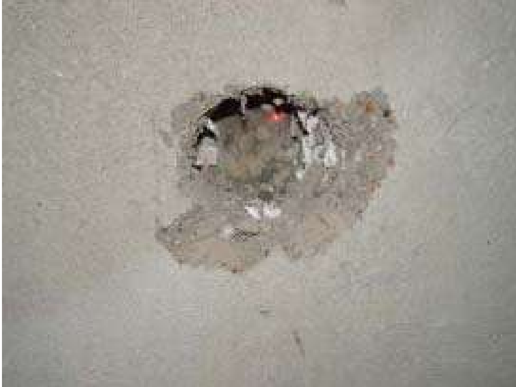
Cratere dell'impatto con il missile della prova di controllo nucleare della II serie
